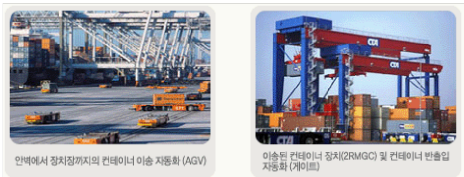
[그림 5] 컨테이너 이송 자동화 및 컨테이너 반·출입 자동화
